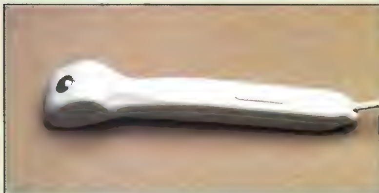
10. Niestety, nie jest to dobre narzędzie. Widoczna na zdjęciu metalowa kulka ślizga się po rolkach i rysując koło otrzymujemy kwadrat.
